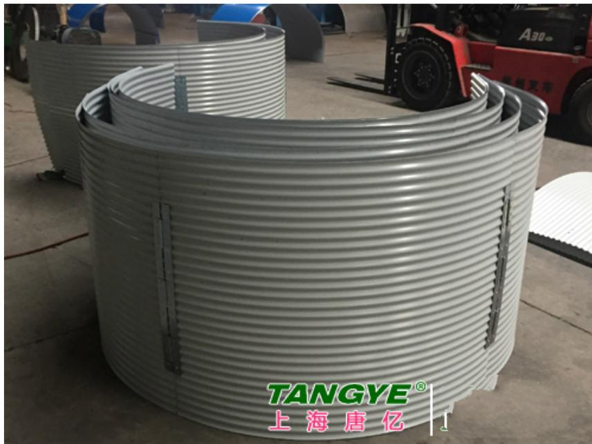
皮带机防雨罩所用彩钢板规格根据不同环境，使用的防雨罩规格也不相同，搭建的方式也不一样。具体参数看下列介绍：1. 板型为900型小波纹，扣除搭接后有效宽度可达到890mm2. 适用胶带宽度为B500-B3000也可以根据客户要求生产特殊形状的防雨罩。3. 彩板厚度为。防雨罩的常用颜色，蓝色，白色，红色，等可以根据客户要求定做。皮带输送机防尘罩安装说明：1. 将Z型钢（矩形管）焊接在机架的上面（机架侧面）2. 将防雨罩从机架的一端向另一端安装，安装时防雨罩上严禁站人，勿用力撞击或敲打。3. 用自攻钉将输送机防雨罩固定在Z型钢上（矩形管上），每片不少4个固定点。4. 安装时搭接1个或2个波纹，有效尺寸为880mm或820mm5.每隔10片安装1片开启罩，（方便维修或查看）。广州全开启式防雨罩上海唐亿公司专业生产输送机防雨罩。
